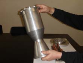
SLR10k-I erzeugt 1 Tonne Schub
