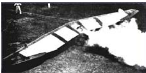
1929: Espenlaub E15. Erstes Flugzeug, welches für die Verwendung von Raketenantrieb konstruiert wurde – vom Schweizer Ingenieur: A. Sohlendorff.
