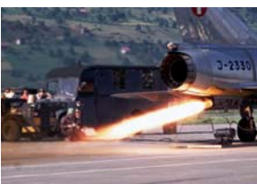
Mirage IIIS: Bodentest Raketentriebwerk SEPR; Foto: Peter Gunti
