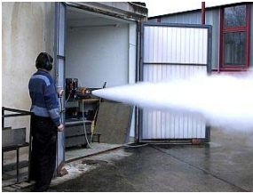
SHWR1.2k-I erzeugt 120 kg Schub
