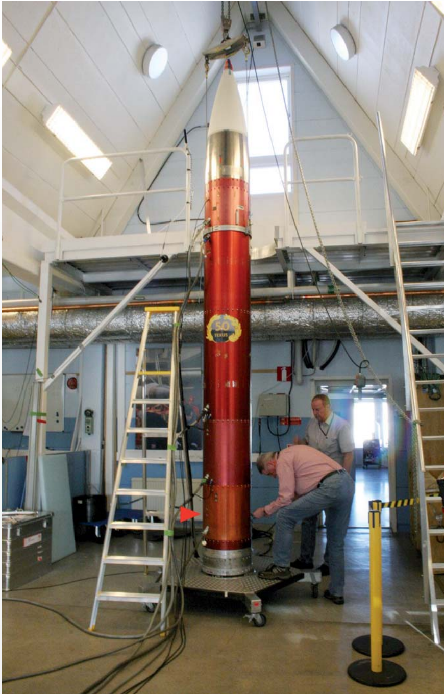
Nutzlastbehälter der Rakete: Das Bio-Experiment befindet sich ganz unten (Pfeil).
