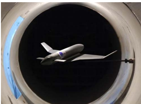
Project Enterprise: Modell im Windkanal Foto: TALIS Enterprise GmbH, 01.11.2007
