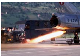
Mirage IIIS: Bodentest Raketentriebwerk SEPR; Foto: Von Gunten
