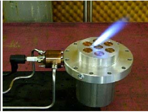
Aktuelles Zündsystem welches mit Ethan/Sauerstoff bzw. Wasserstoff/Sauerstoff betrieben werden kann. Auf dem Bild sieht man wie die Flamme aus dem Einspritzkopf eines Triebwerkes mit 4 kN austritt. Der eigentliche Zünder befindet sich links und besteht aus einer Kupferlegierung.
