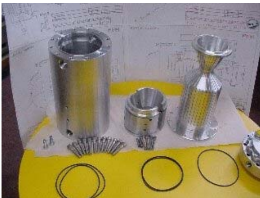
Die Einzelteile des Triebwerkes. Es ist komplett zerlegbar und kann somit nach jedem Einsatz inspiziert werden. Besonders wichtig ist die Inspektion der Kühlkanäle welche bei anderen Konstruktionen nicht zugänglich sind. Klicken Sie auf das Bild um eine grössere Version zu sehen.
