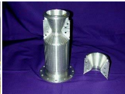
Der innere Liner der Brennkammer mit den gefrästen Kühlkanälen. Der Düsenhals ist mit einem genaustens bearbeiteten Sattelstück umschlossen. Die Temperatur der Flüssigkeit in den Kühlkanälen kann mit kleinen Thermoelementen gemessen werden. Klicken Sie auf das Bild um eine grössere Version zu sehen.
